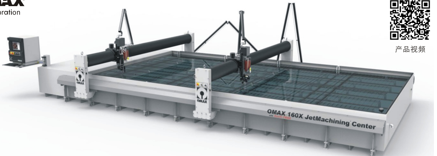
样机展示可选购的双龙门架, Tilt-A-Jet切割头和A-Jet 配件
